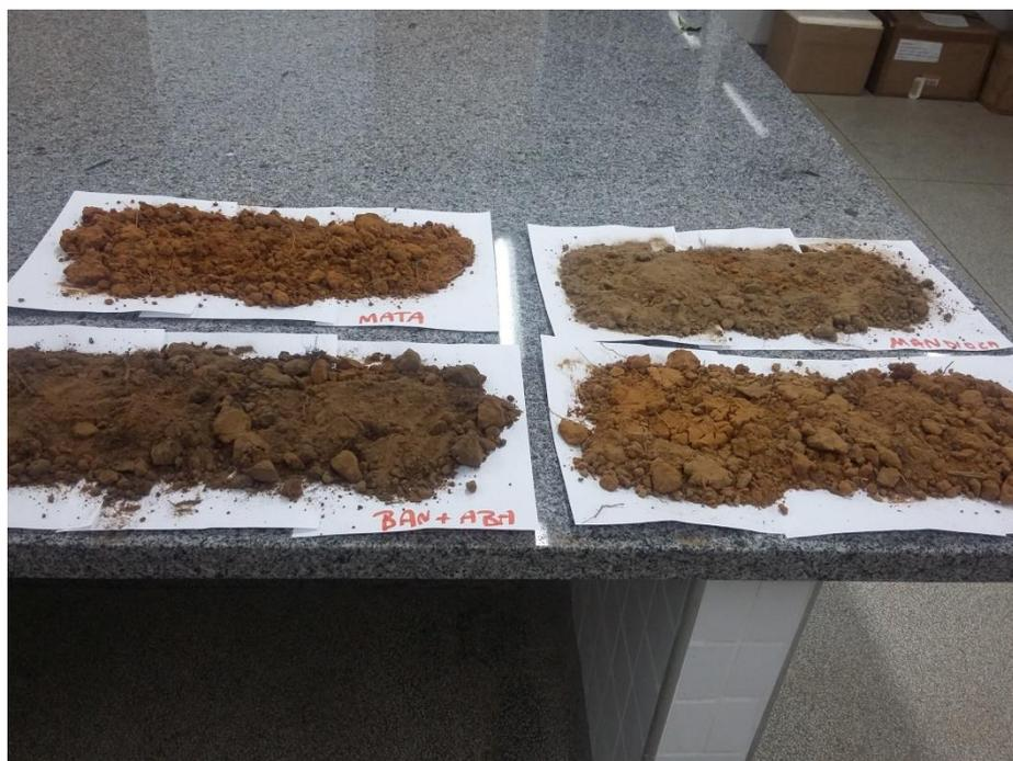
**Figura 4.** Amostras de solo secando ao ar à temperatura controlada de 25°C. (Foto: autoria própria)
