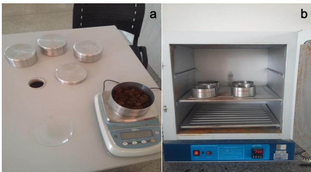
**Figura 3.** a) Pesagem das amostras de solo fresco; b) secagem a 105°C em estufa.
